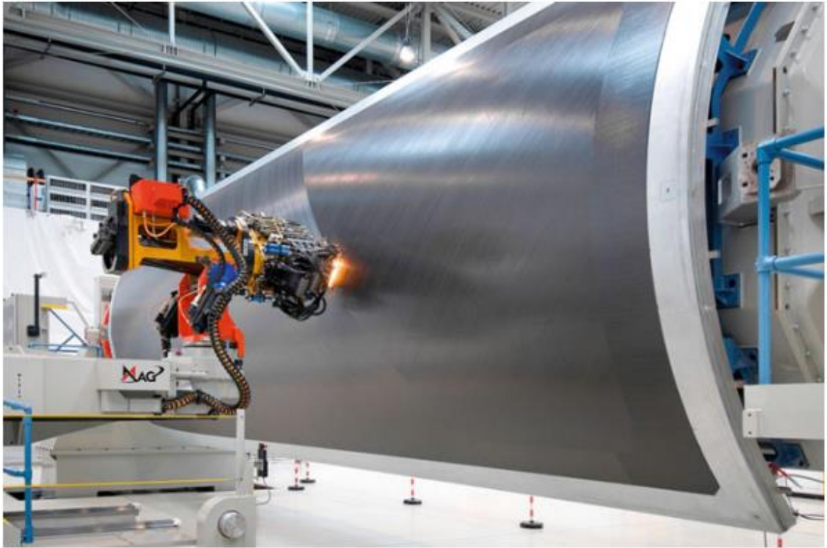
ფიგურა 2.7 შრეების ავტომატური აწყობა. ეს არის ამწყობი მოწყობილობა, რომელიც გამოიყენება კომპოზიტების საწარმოებლად
