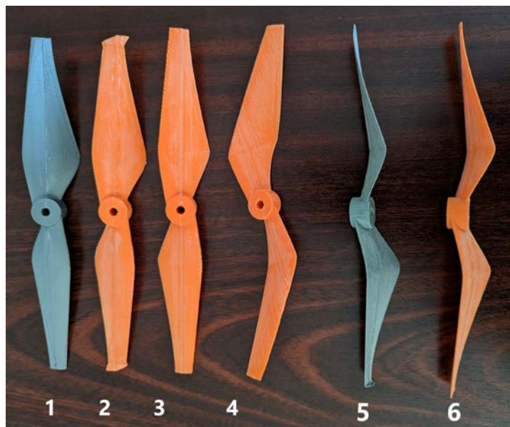
ნახ.3.10 საჰაერო ხრახნების დამზადებული მოდელები: 1)ნორმალური, 2)ოპტიმიზებული პროპლეტებით, 3)ტურბულიზატორებით, 4)ფრთოვანების ისრისებურობით, 5)რევერსულ თოლიასებრი პროპლეტებით, 6)რევერსულ თოლიასებრი
