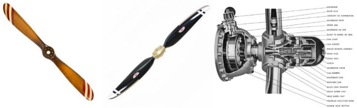
ნახ.1.7 საჰაერო ხრახნების ფრთოვანების/ნიჩბების დაყენების კუთხის მუდმივი, ხელით ცვალებადი და ავტომატურად ცვალებადი კონსტრუქციები.
