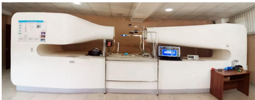
ნახ.1 კომპიუტერული გაზომვის სისტემით აღჭურვილი სსუ აეროდინამიკური მილი
