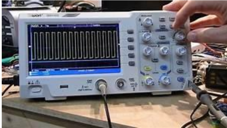
ნახ.3: ელექტრონული ციფრული ოსცილოსკოპი OWON SDS1102
